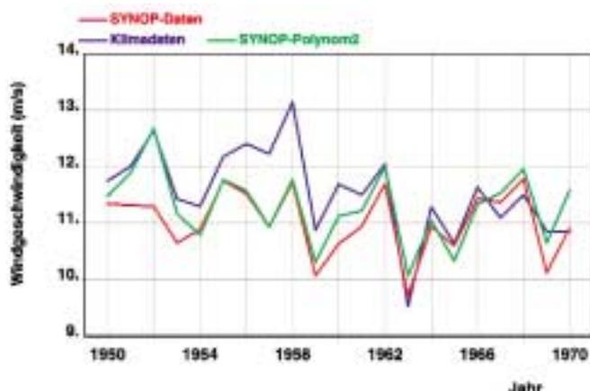
**Abb. 2** Vergleich der Jahresmittelwerte des geostrophischen Windes aus verschiedenen Berechnungsmethoden für den Überlappungszeitraum 1950-70.
