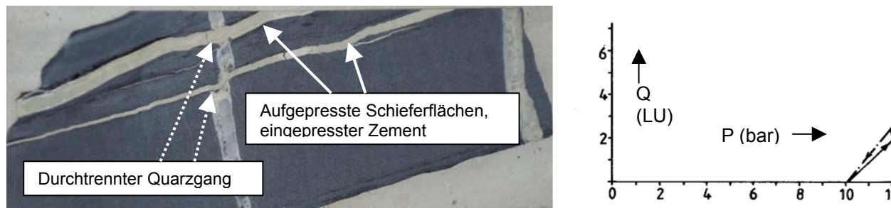
Abbildung 2: Zementsteinlagen in aufgedrückten Schieferflächen trennen quarzgefüllte Klüfte; kritischer Druck P_{crit} \leq 12 bar
