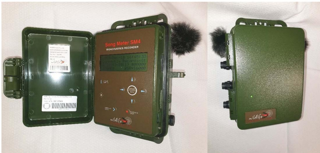
Abb. 33: Akustikrekorder Songmeter SM4, Wildlife Acoustics USA, links geöffnet © O. Keuling
