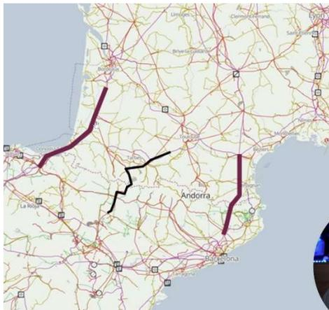
**Bild 4.** Die drei Leitungen, über die Strom zwischen Spanien und Frankreich ausgetauscht wird ([Grafik: Webseite „Outdoor Chiemgau“<sup>4\)</sup>](#))
