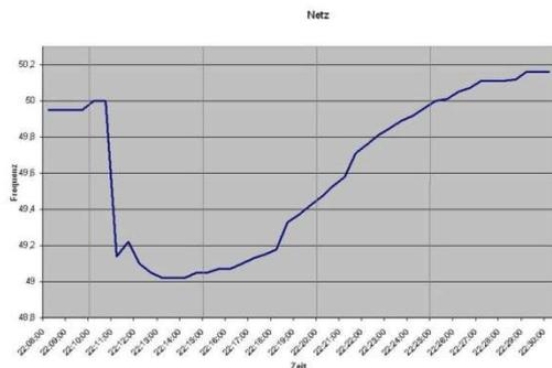
**Bild 1.** Aufzeichnung des Frequenzverlaufs des Stromnetzes im unterversorgten Ruhrgebiet am 4.11.2006 zwischen 22:08 und 22:30 MEZ ([Grafik: Wikipedia, Creative Commons](#)<sup>3)</sup>)
